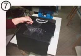
7 Appliciamo con una termopressa ad una temperatura di 150° C/160° C per 15 secondi con una pressione media.
