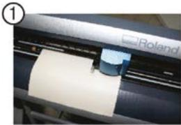
1 Con un programma di grafica vettoriale realizziamo il disegno con dei cerchi. Intagliamo lo stencil con un plotter da taglio utilizzando una lama con angolazione a 32°. Far eseguire 2 volte il percorso di taglio per ogni singolo cerchio.
